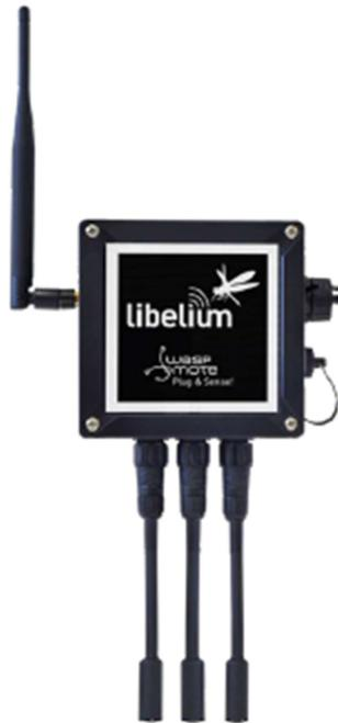
Figure 5 Equipement Libelium, son Antenne et sondes connectées
