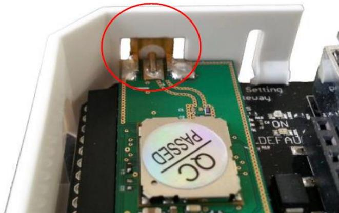
Figure 3 Connecteur d'antenne LoRa
