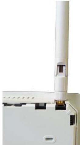
Figure 11 Installation de l'antenne LoRa
