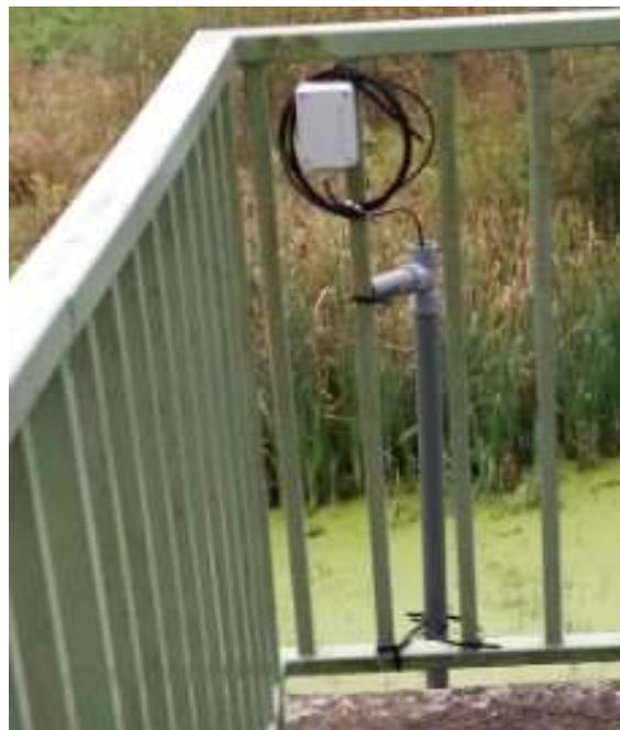
Figure 2 Fixation sur grille
