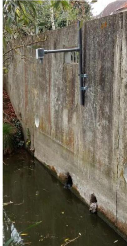
Boîtier fixé sur un support avec tige de déport
