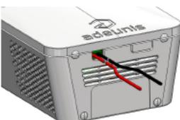
Afin de pouvoir coupler un capteur de contact sec avec le produit et bénéficier ainsi de son entrée TOR2 il est nécessaire de brancher le capteur au bornier de la carte.
